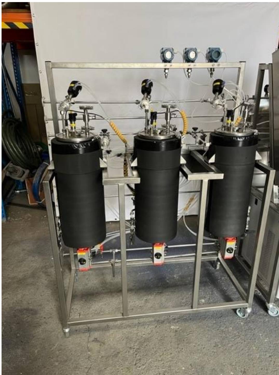
Obrázek 13 - Rafinační jednotka na bázi mobilní fáze.
