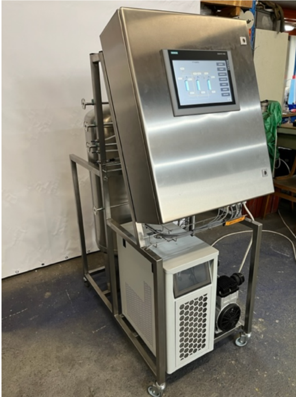
Obrázek 18 - Centrální řídicí jednotka s dotykovým displejem, chlazení, zdroj vakua a zdroj tlakového vzduchu.
