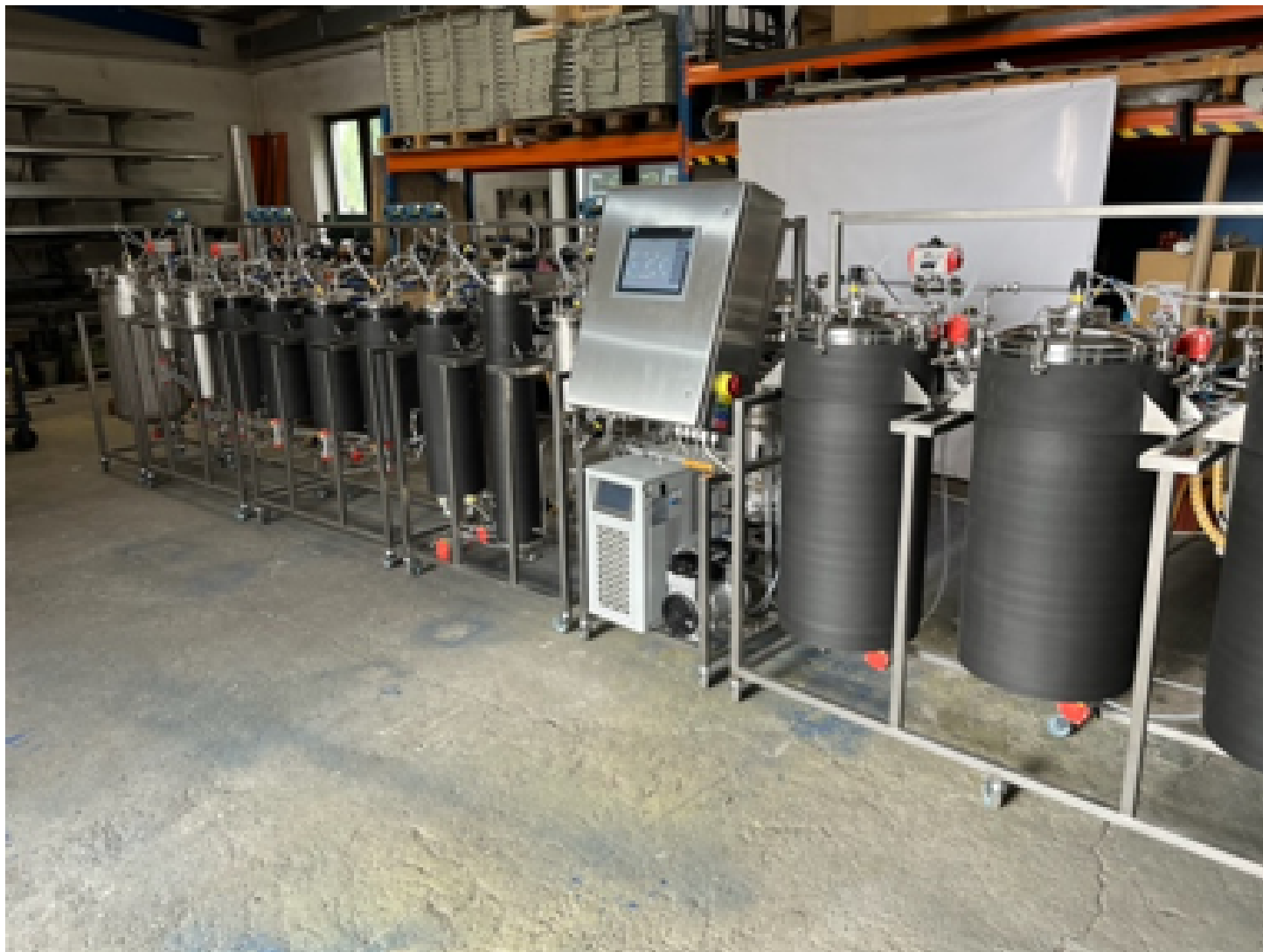
Obrázek 31 - Maximální průmyslová sestava obsahující zleva: obě extrakční nádoby (A, B), rafinační reaktor, rafinační jednotky na bázi mobilní fáze, vakuovou destilační kolonu, dekarboxylační reaktor, řídicí jednotku se zdrojem chladu vakua a tlakového vzduchu, chlazení ethanolu a zásobník použitého rozpouštědla.
