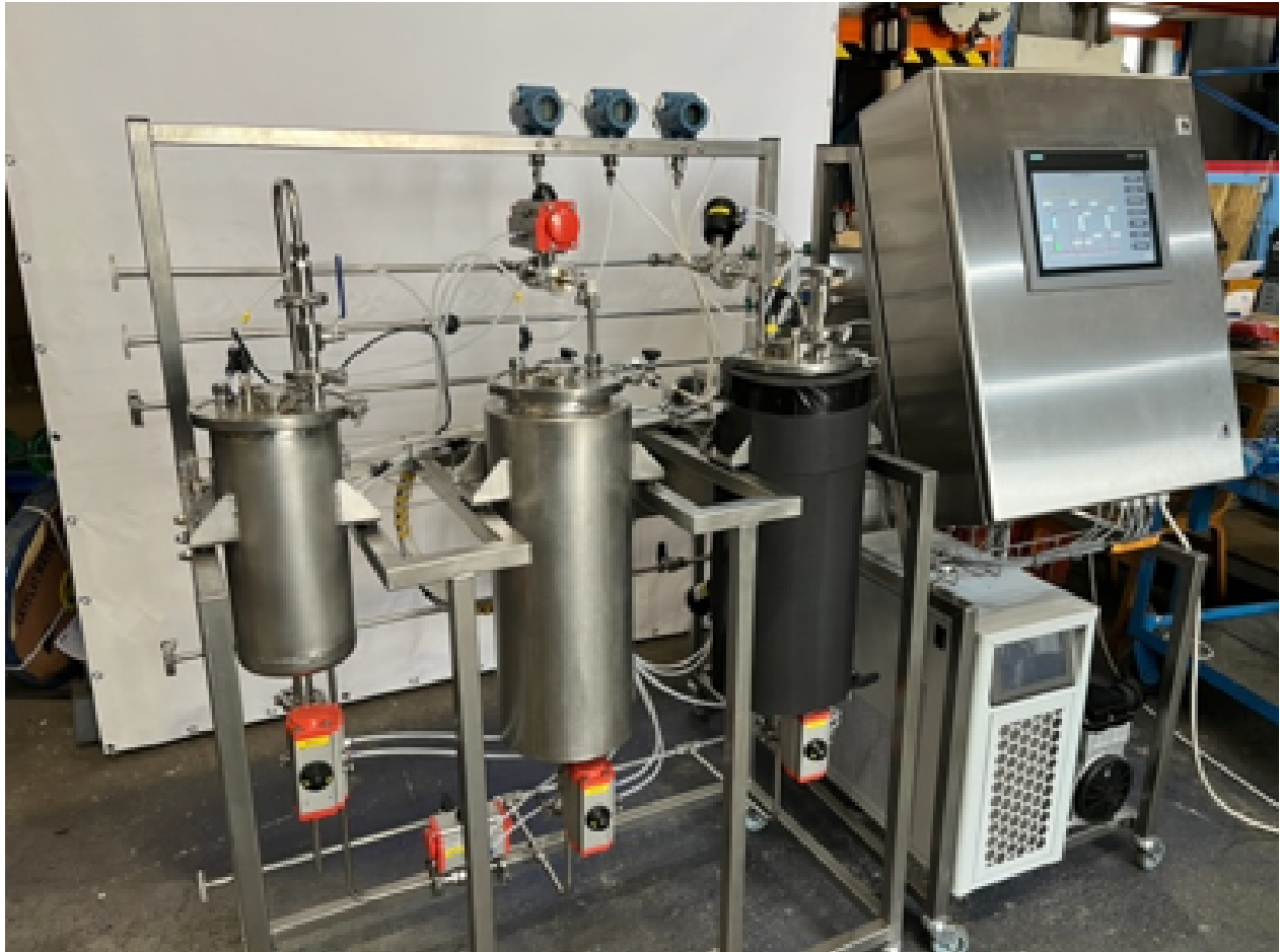
Obrázek 26 - Malý extraktor (A) + rafinační reaktor a zásobník proplachu samostatně umožňující výrobu herbálních tinktur (přibližný objem výroby 12 l/h).
