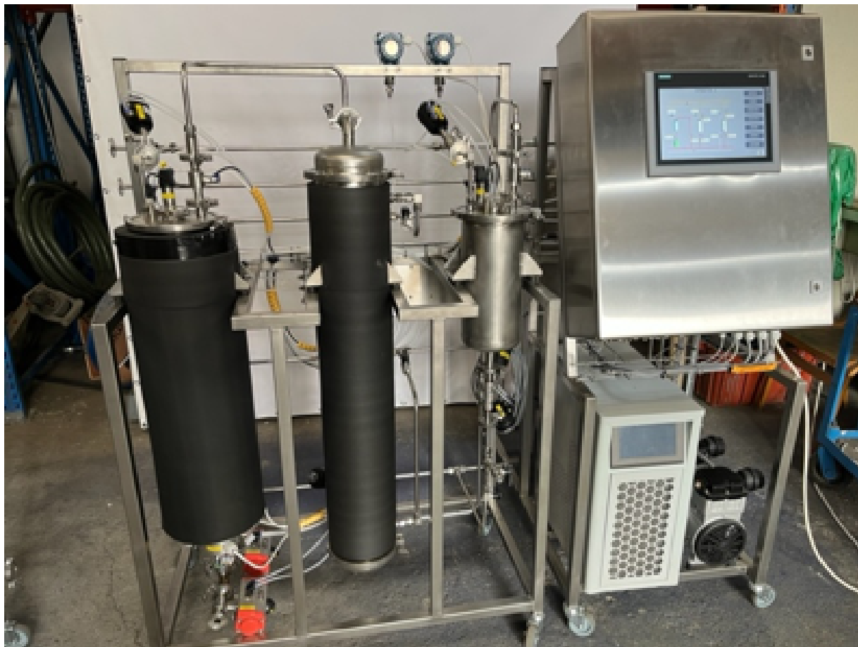
Obrázek 29 - Samotná vakuová odparka se speciálním dekarboxylačním reaktorem umožňující zpracování herbálních macerátů a řízený rozklad karboxylových kyselin.
