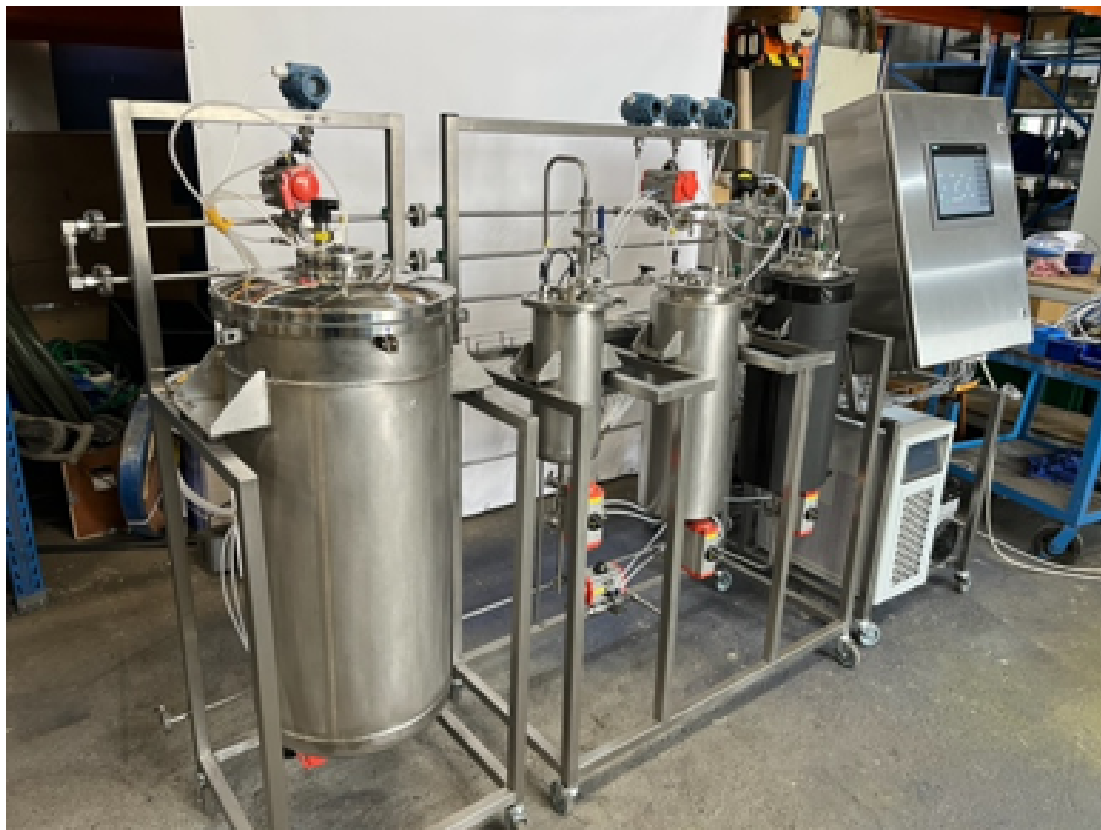
Obrázek 27 - Velký i malý extraktor (A,B) + rafinační reaktor a zásobník proplachu samostatně umožňující velkokapacitní výrobu herbálních tinktur (přibližný objem výroby 70 l/h).
