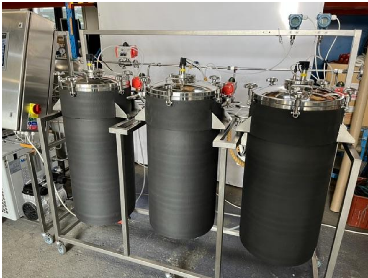
Obrázek 17 - zásobníky na chlazení ethanolu umožňující recyklaci dle správné výrobní praxe.
