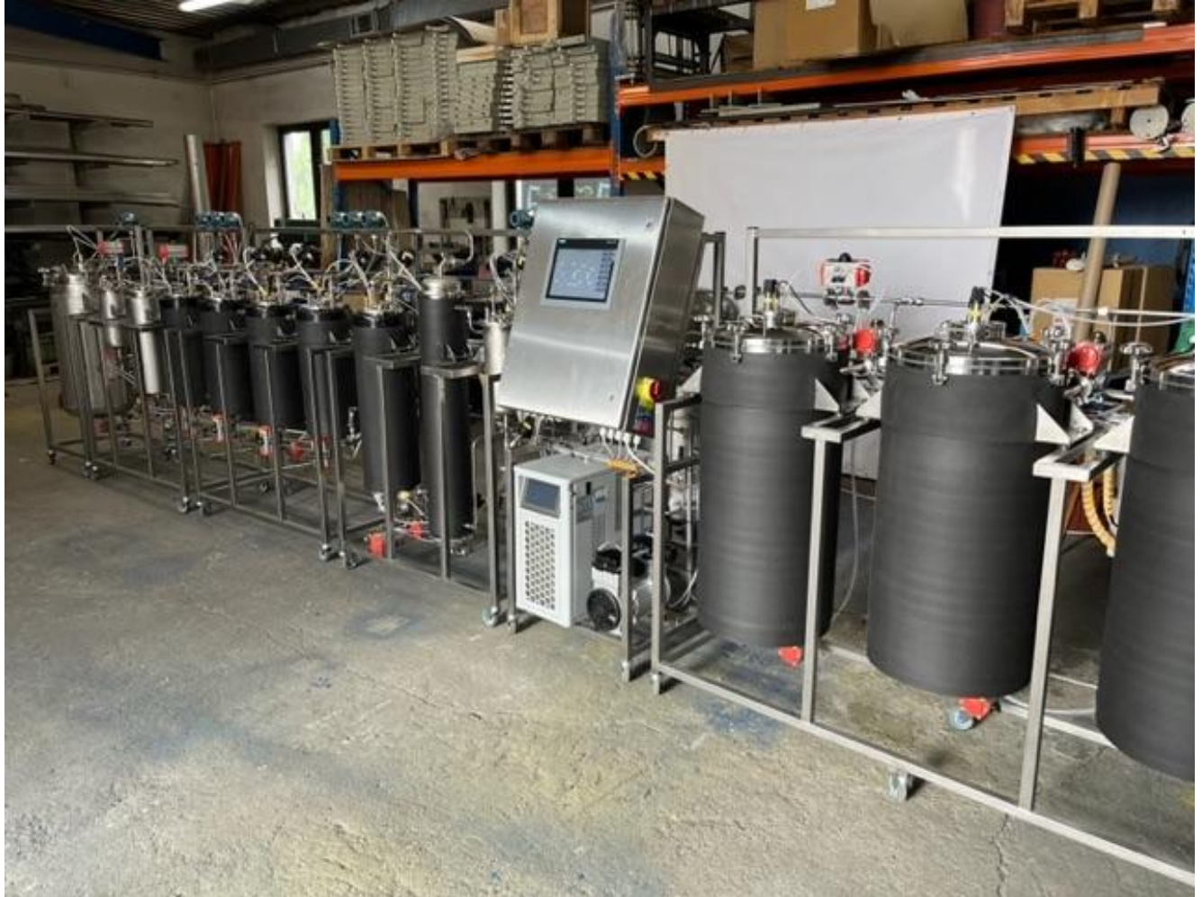
Obrázek 1 - Průmyslová extrakčně-rafinační jednotka v kompletním zapojení v místě realizace žadatele v Horoušanech.
