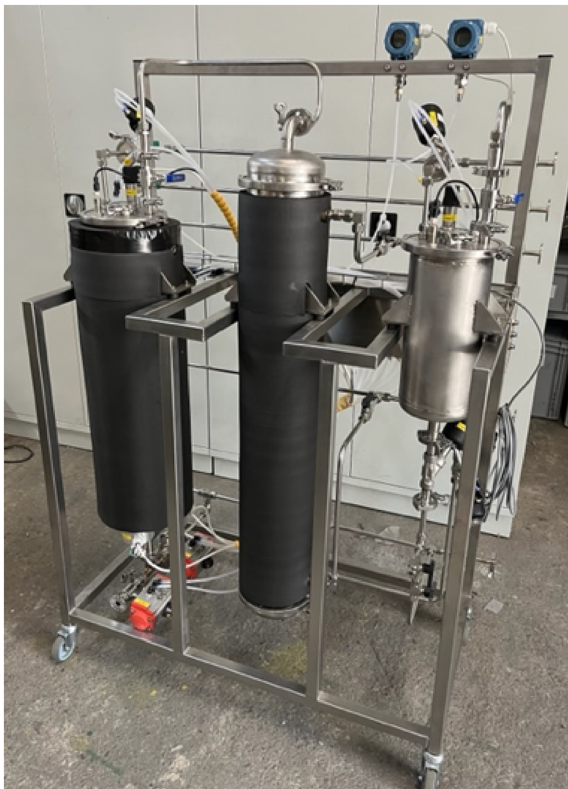
Obrázek 16 - Vakuová odparka se speciálním reaktorem umožňujícím dekarboxylaci
