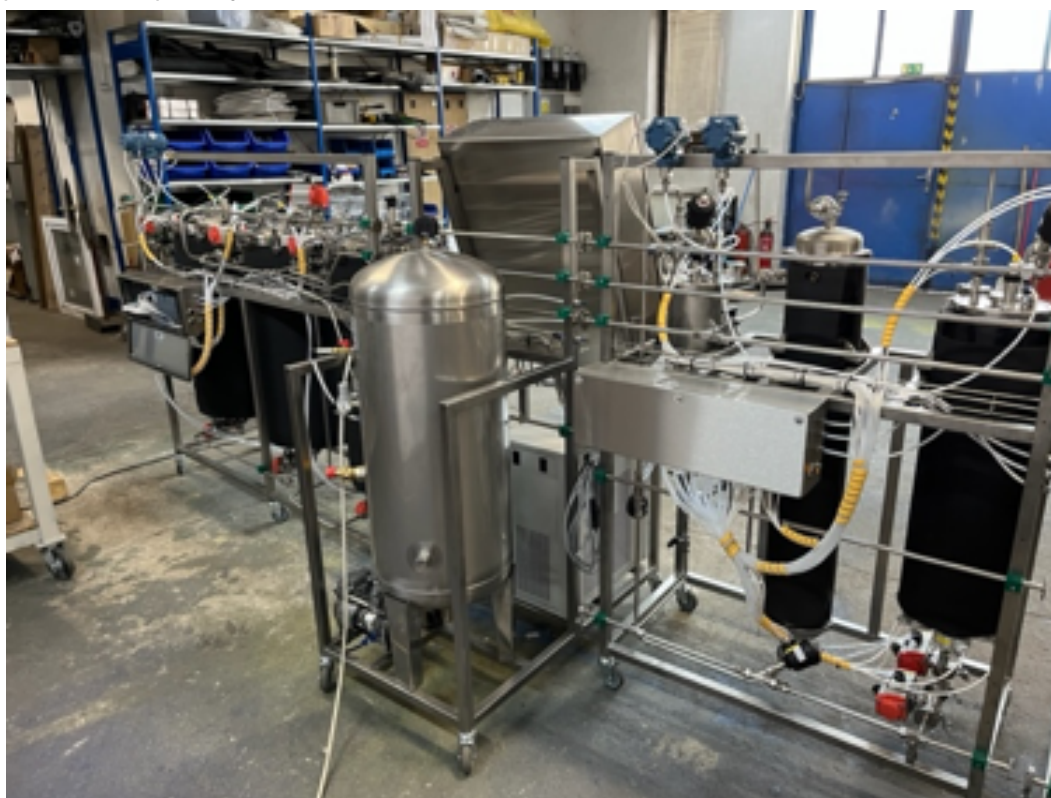
Obrázek 12 - Uprostřed nádoba na tlakový vzduch sloužící jako hnací síla pro
