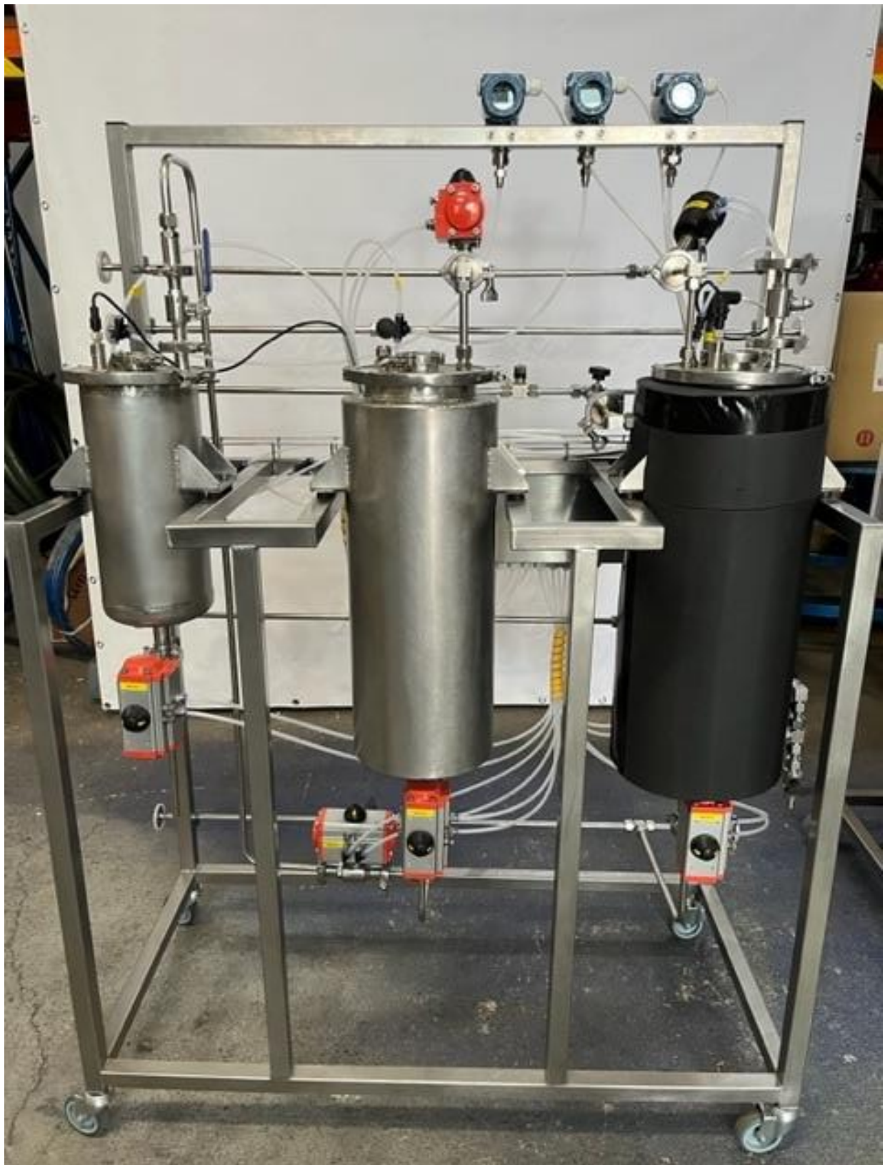
Obrázek 5 - Dílčí Prototypy II a III instalované na společné rámové konstrukci. Zleva: zásobník na proplach, extrakční nádoba malá a rafinační reaktor.
