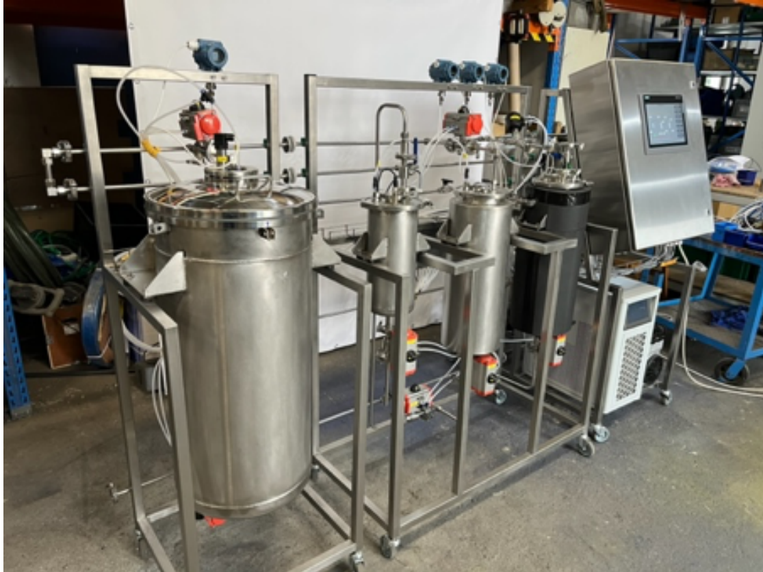
Obrázek 8 - Na levé straně Extraktor B - velikostně opovídající průmyslovému využití.
